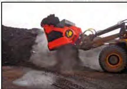
Аэрация илового компоста
