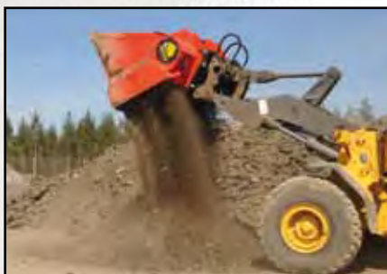
Аэрация компоста загрязненной почвы
