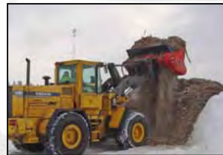
Аэрация компоста из биоотходов
